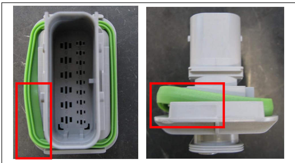
Figure / Abbildung 3.6.2.3 Axial seal slipped out of the groove / Axialdichtung aus der Nut gerutscht
