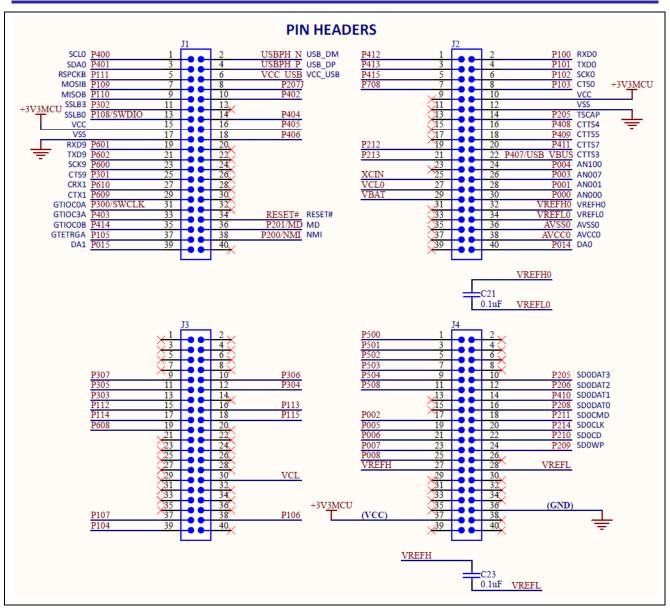
Figure 23. TB-S5D3 Pin Headers Circuit
