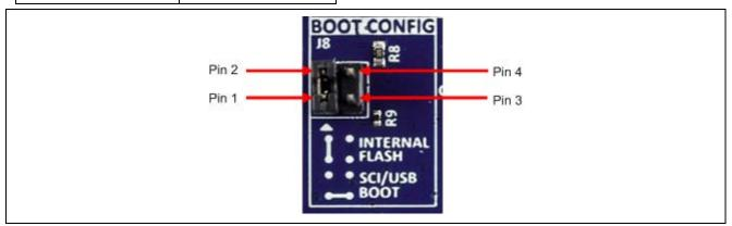
Figure 28. Boot Config Jumper J8
